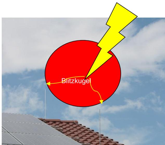
Bei der Planung der Fangeinrichtung wird gedanklich eine „Blitzkugel“ mit dem der Blitzschutzklasse entsprechendem Radius über das Objekt „gerollt“. Durch die Anordnung und Höhe der Fangeinrichtungen (Fangspitzen, Fangstangen, Fangmasten) ergibt sich ein Schutzbereich. Die Blitzkugel liegt sozusagen auf den Fangeinrichtungen auf und berührt das zu schützende Objekt nicht.
