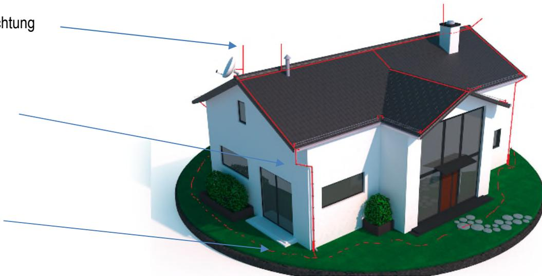
Ob der installierte Blitzschutz vorschriftsgemäß installiert wurde und funktionstüchtig ist, die Erdungsanlage einwandfrei und alle Verbindungen ins Gebäudeinnere einschließlich (Blitzschutz-) Potentialausgleich vorhanden sind, kann nur nach einer umfassenden Prüfung und Messung festgestellt werden.
